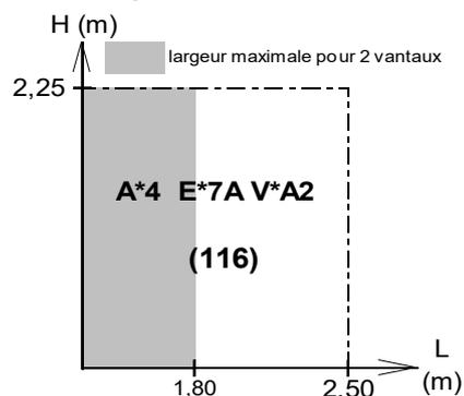
**DIMENSIONS MAXIMALES (HORS COFFRE) DES FENÊTRES EQUIPANT LES BLOCS-BAIES
